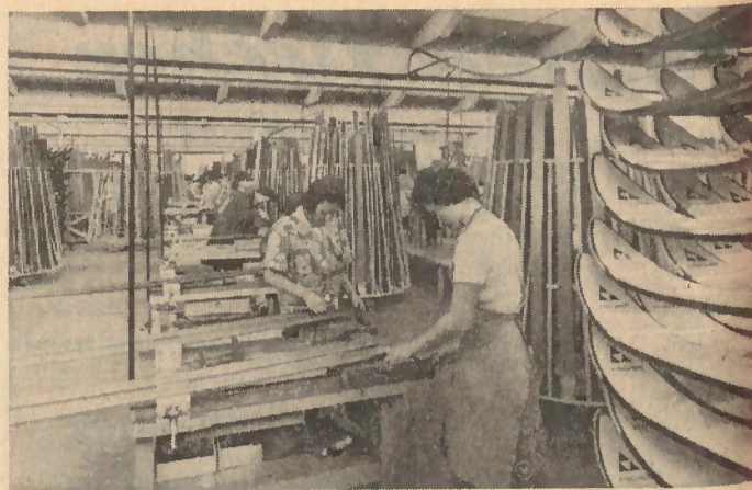
Obwohl die Skifabrik Fischer jährlich Millionen Schillinge zur Modernisierung der Arbeitsplätze ausgibt — in diesen Monaten hat Fischer das modernste Sägewerk Europas in Betrieb genommen — können nach wie vor viele Arbeiten nur mit der Hand verrichtet werden, wie hier die Montage der Spitzenschoner.
