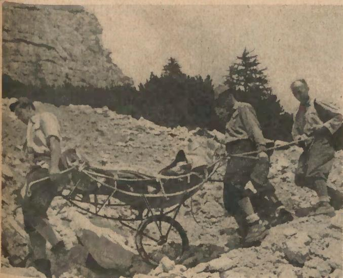
Der Leichtmetall-Akia kann mit wenigen Handgriffen mit einem Fahrgestell mit luftbereiftem Einrad versehen werden. Foto L. Gramminger
